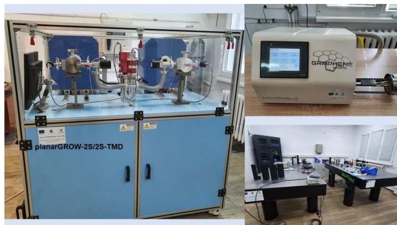
Фиг.3. CVD система за отлагане на 2D нанослое от халкогениди на преходни материали; нано CVD система за синтезиране на графен; система за оптични и електро-оптични изследвания.
